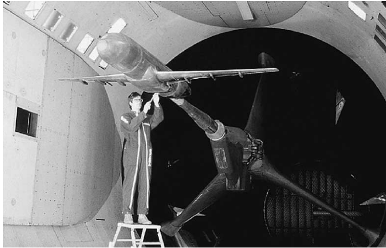
Figure 10. Essais sur une maquette d'A320 à la soufflerie S1 de l'ONERA/Modane.
