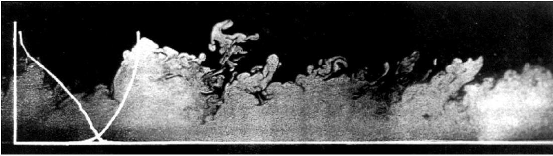
Figure 3. Visualisation de la région externe d'une couche limite turbulente [34].
